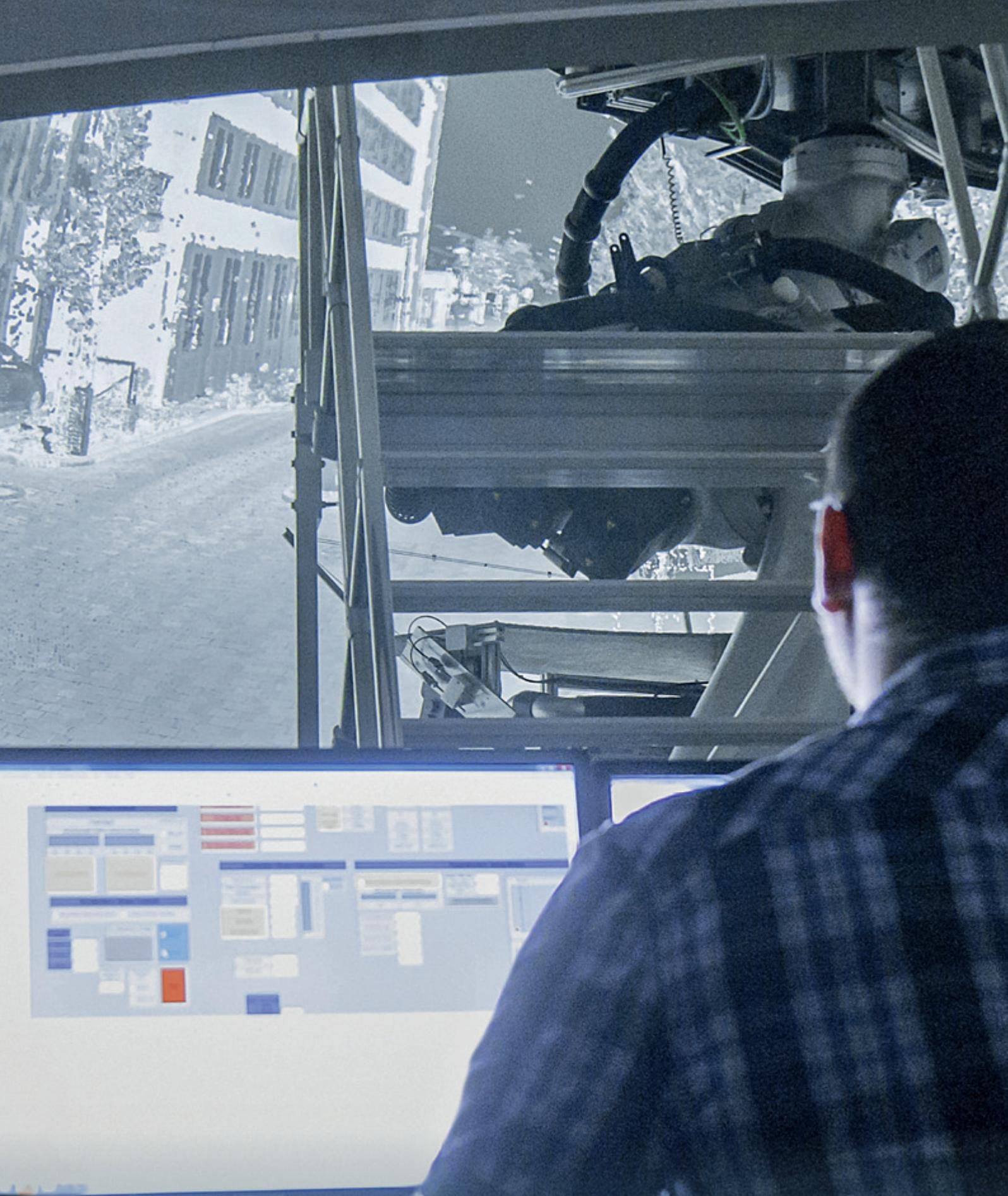
Zur Untersuchung des Fahrereinflusses in frühen Projektphasen gibt es am ITWM die Simulationsplattform RODOS® und das 3D-Laserscanner-Fahrzeug REDAR. Das Szenariodesign nutzt georeferenzierte 3D-Laserscanner-Punktwolken mit Subzentimeter-Auflösung, so dass die optische Komplexität der Szenen nahezu der Realität entspricht. Mit dieser Technik können ganze Städte zur virtuellen Fahrzeugerprobung in der Echtzeitsimulation nachgebildet werden.
